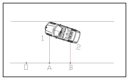
Esempio: si tracciano sulla strada i punti O, A, B, 1 e 2. Si misurano: OA, A1, AB, B2. Le misure A1 e B2 devono essere condotte perpendicolarmente all'allineamento OB.
